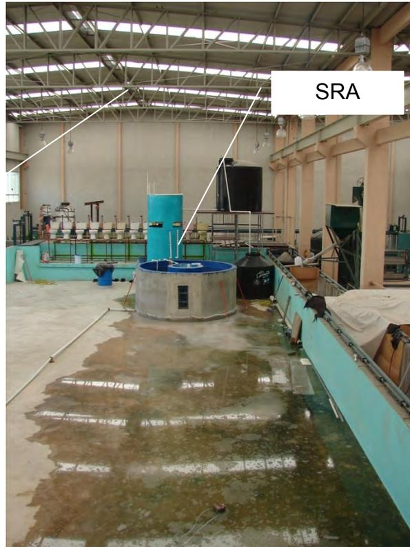
Figura 12. Prototipo construido en la playa de modelos a escala reducida del laboratorio de modelos hidráulicos.
