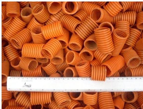
Figura 16. Empaque utilizado en el biofiltro (poliducto flexible)
